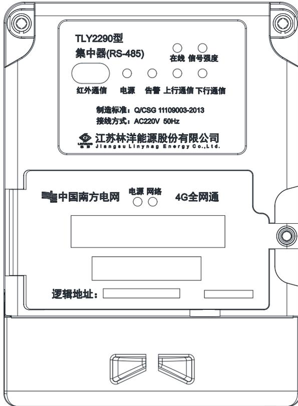
图1 集中器外观结构示意图（下行通信为RS-485方式）
