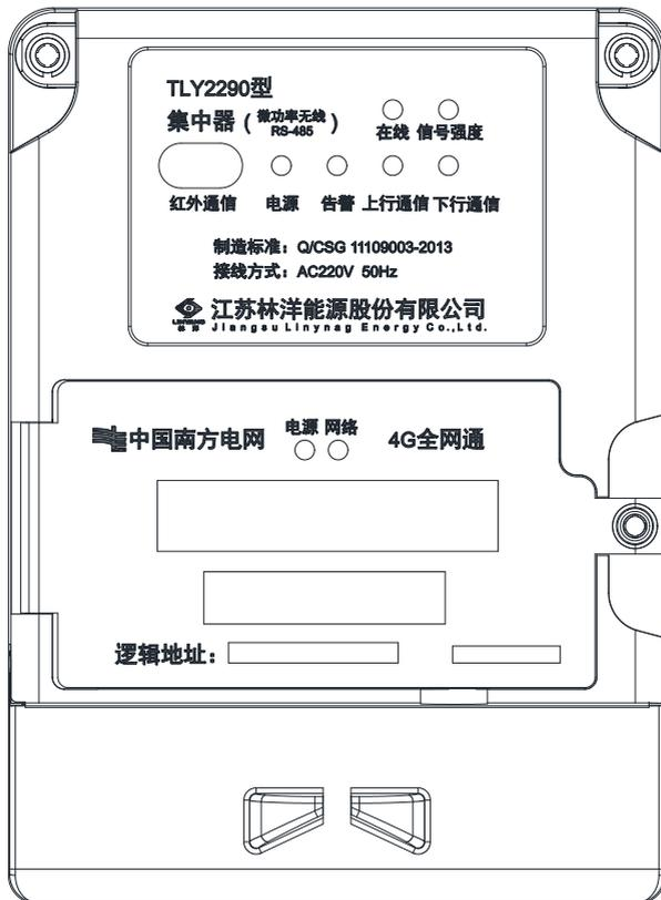
图2 集中器外观结构示意图（下行通信为RS-485/微功率无线方式）
